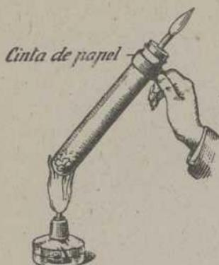
Fig. 2. Destilación seca del carbón.
