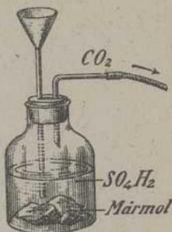
Fig. 56. Preparación del  $\text{CO}_2$ .
