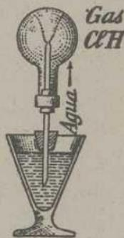
Fig. 33. El gas clorhídrico se disuelve en el agua.
