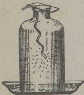
Fig. 10. Combustión de un muelle.
