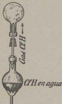
Fig. 32. El matraz se llena de gas clorhídrico.
