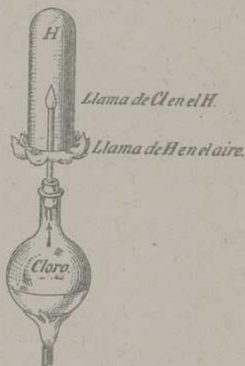
Fig. 30. El cloro arde en el hidrógeno.
