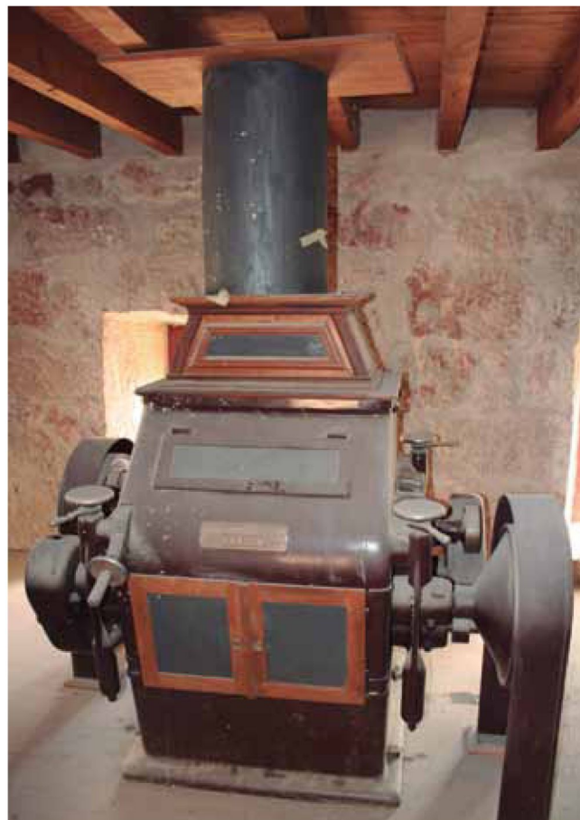
Molino de cilindros de la Fábrica de Harinas La Concha en Ciudad Rodrigo, Salamanca.
