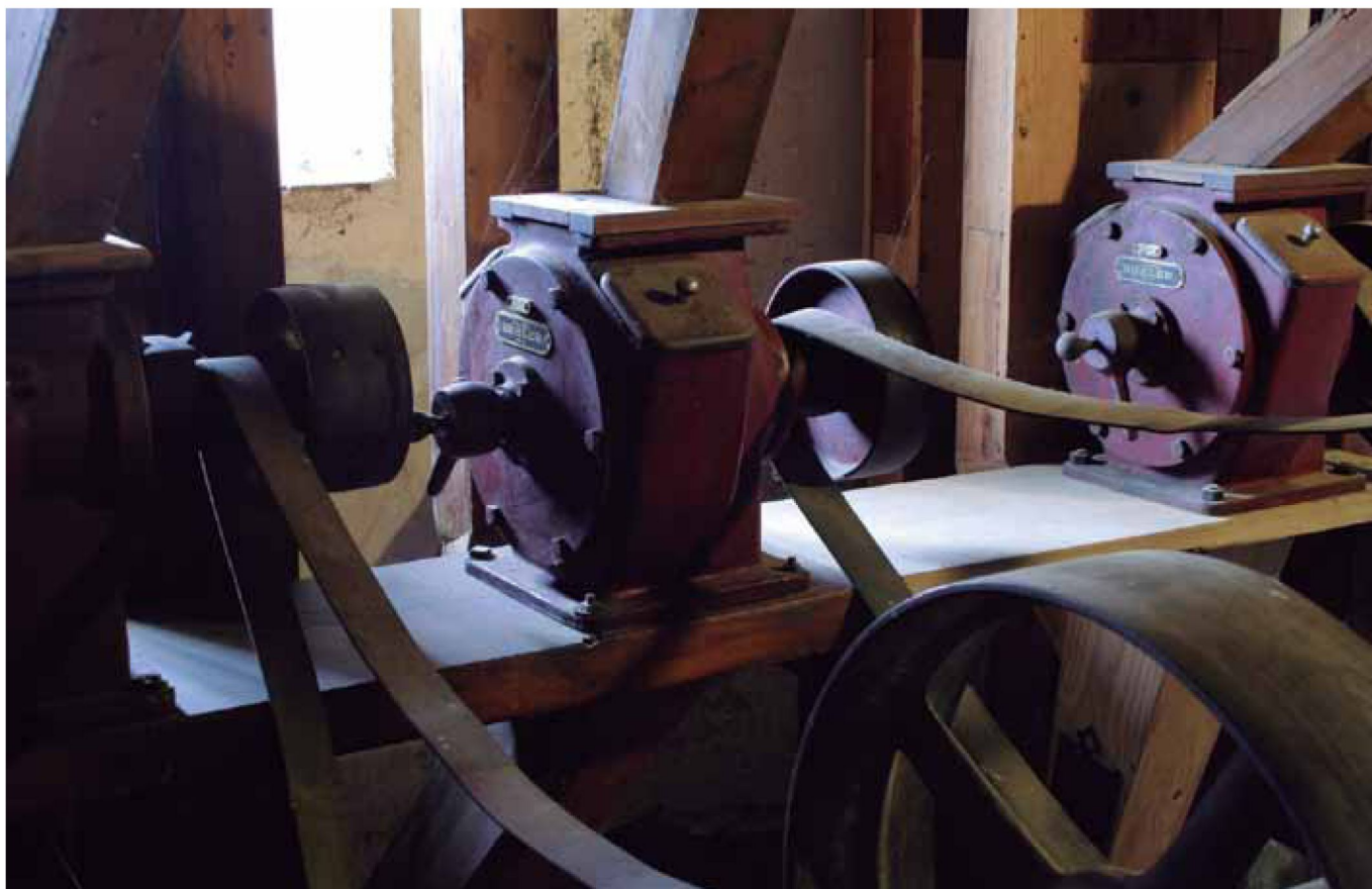
Disgregador. El desatador reductor de plaquetas se encarga de eliminar las placas que se producen en la compresión. Luego el producto sube el cernido que comienza en los plansichter en la tercera planta.
