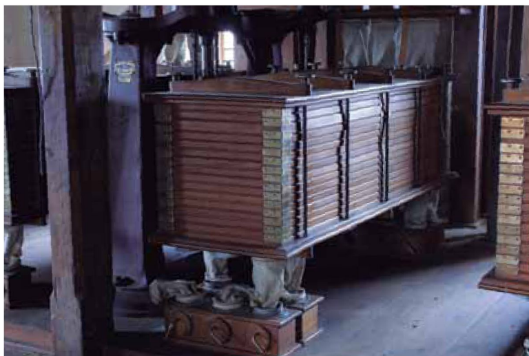
Los plansichter reciben los productos de los molinos y los clasifican
