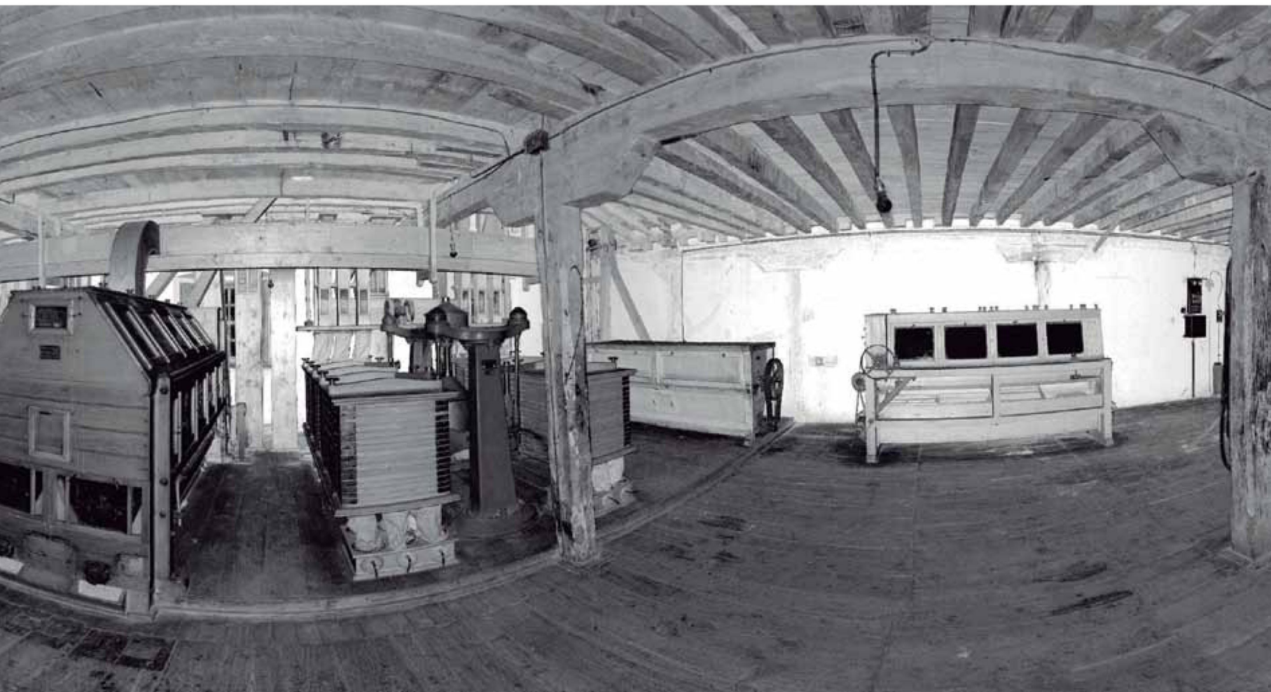
Modelo de nube de puntos obtenido con el escáner láser Optech3D
