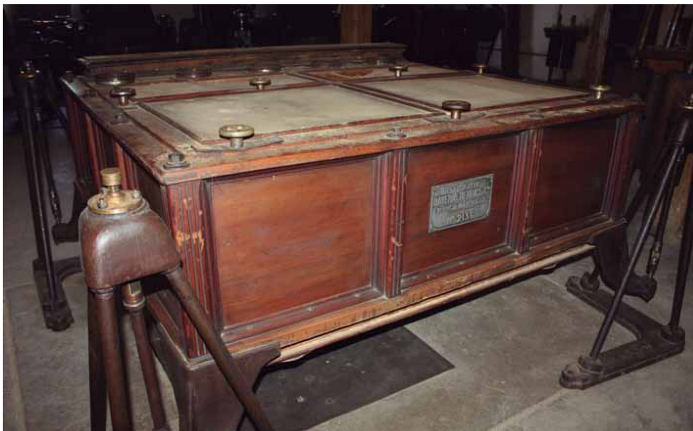
Plansichter creado por Daverio, Henrici & Cie hacia el año 1900 que se expone en el museo de la harinera de Medina de Rioseco, donde trabajó hasta los años cuarenta
