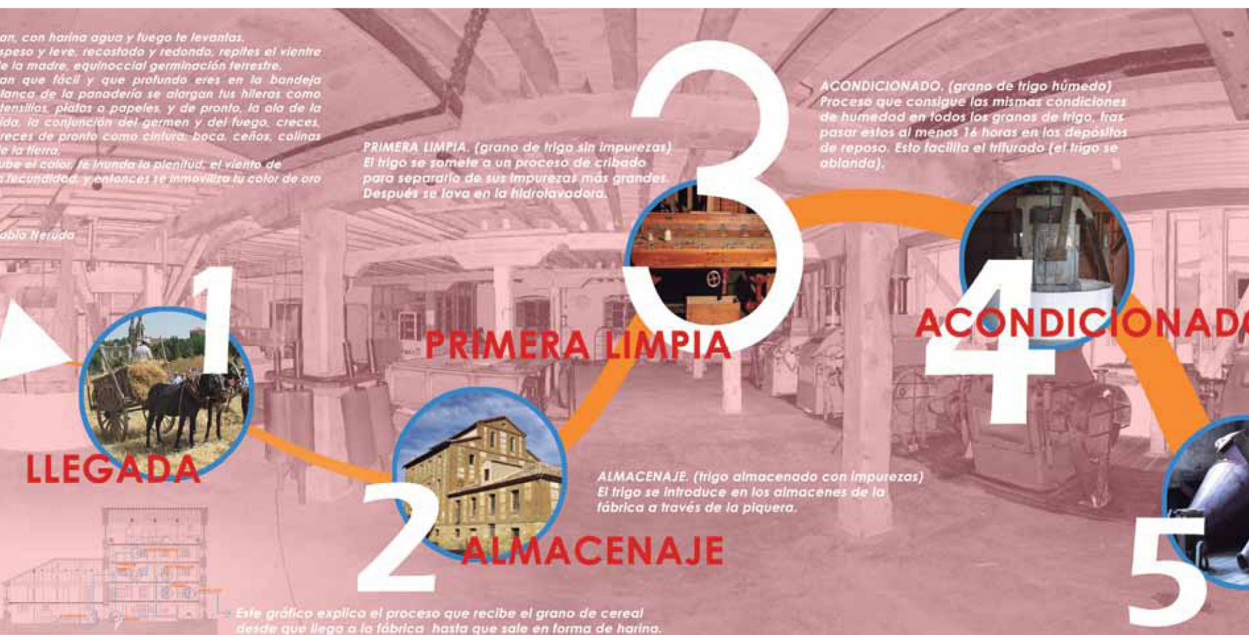
Esquema del funcionamiento de la fábrica realizado para la documentación didáctica.
