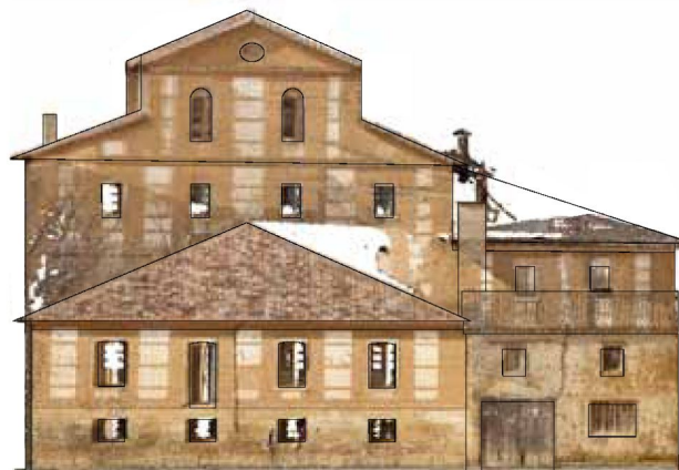
Planta baja de la fábrica de harinas San Antonio y ortoalzados de las fachadas, obtenidas a partir del modelo de nube de puntos.
