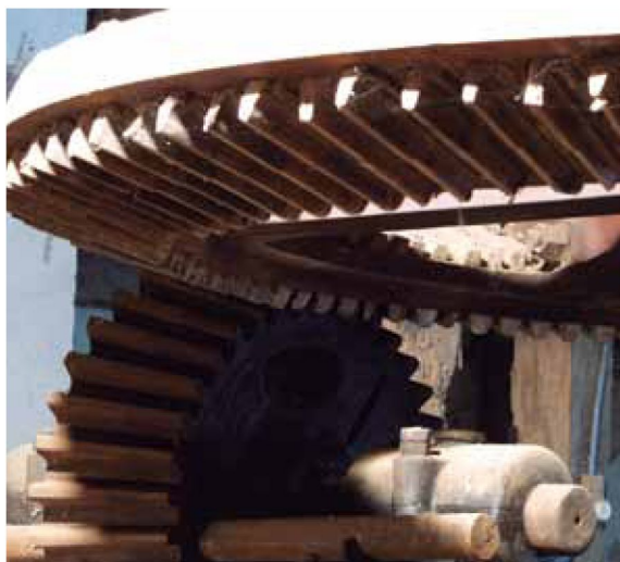
Compuerta para el control de la entrada del agua, detalle de los engranajes de la corona y volante de control de la entrada de agua.
