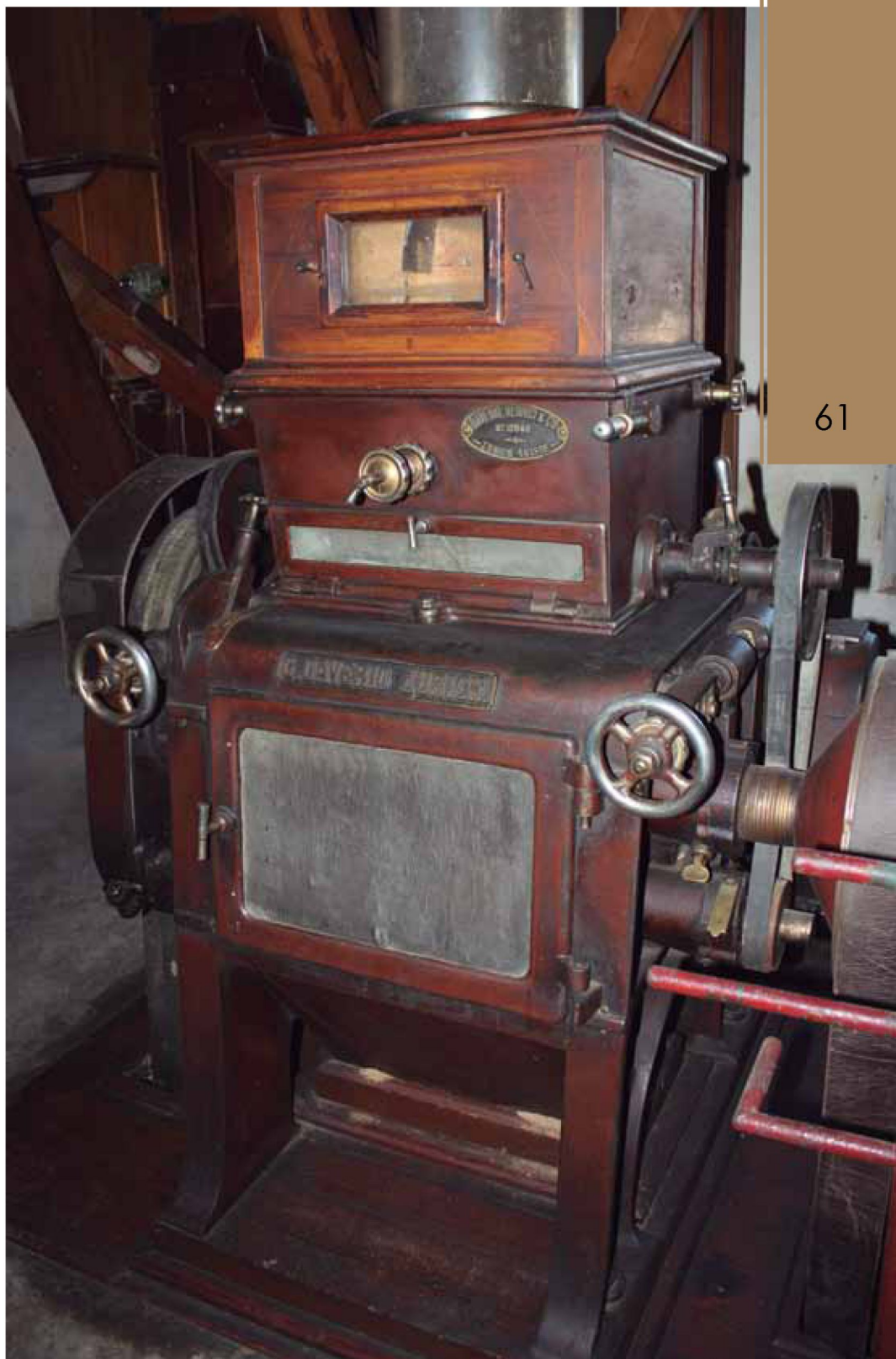
Molino de cilindros marca Daverio, modelo standard de finales del siglo XIX, instalado en la fábrica de harinas "San Antonio" de Medina de Rioseco donde funcionó hasta su cierre en 1993.
