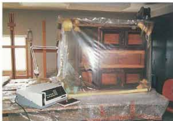
Desinsectación por el sistema de gas inerte
