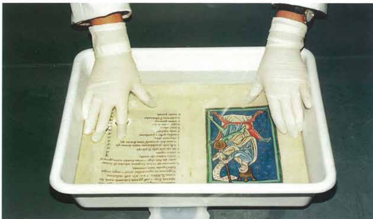
Proceso de lavado e hidratación por inmersión en cubeta
