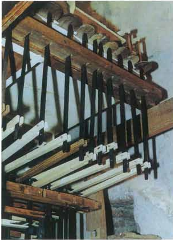
Mecánica de Registros: árboles y espadas de forja, listones y tiradores de pino. Algunos nuevos después de la reconstrucción de registros
