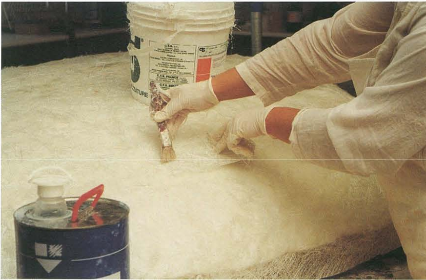
Construcción de carcasa de poliéster y fibra de vidrio.
