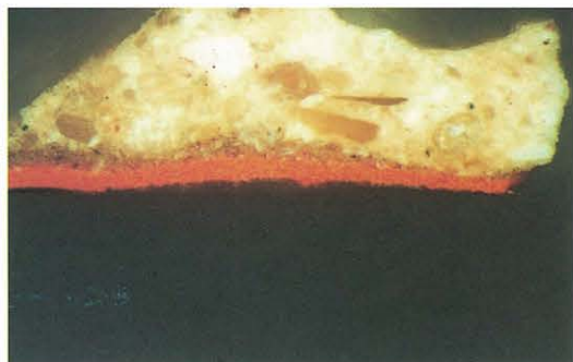
Estratigrafía. Rojo del manto y preparación ocre.
