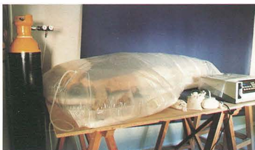
Desinsección de la pieza con gases inertes.
