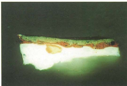
Estratigrafía. Preparación de blanco de plomo e imprimación ocre.
