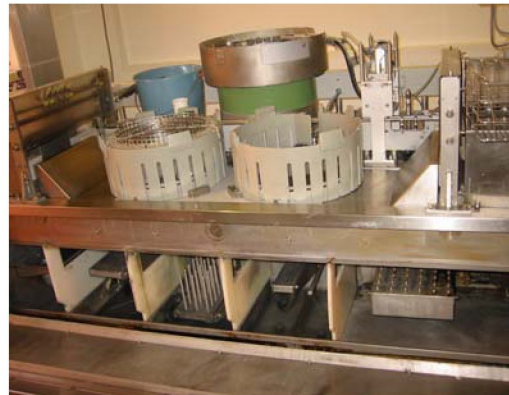
Figura 8. Lavador, secador e inyector de un líquido de tubos de muestras ya utilizados
