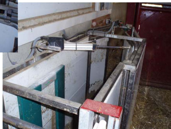
Figura 6. Vistas del pasillo con arco de identificación de los animales y puertas hidráulicas; para distribución de las ovejas hacia diferentes espacios.
