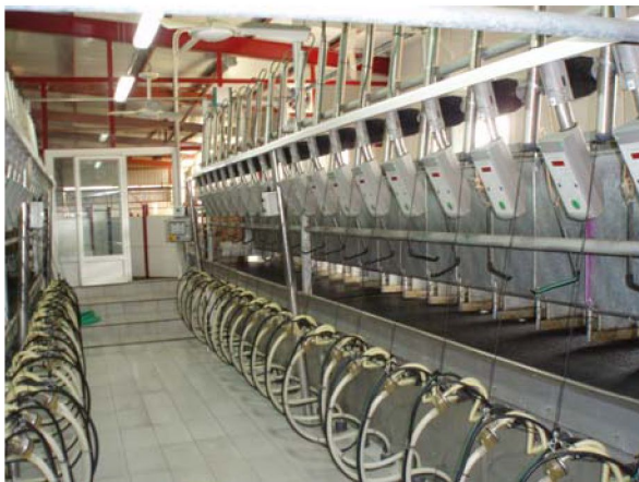
Figura 4. Moderna sala de ordeño de ganado ovino, distribuida en dos niveles. En la foto se observa la zona superior donde se instalan las ovejas; se observa la línea baja de ordeño y los medidores electrónicos.
