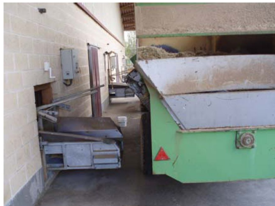
Figura 6: carga de las cintas desde el exterior de la nave mediante carro unifeed
