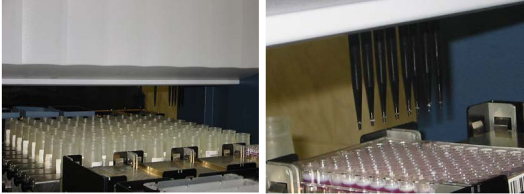
Figura 4. A la izquierda, tubos con muestras de leche recogidas en explotación, dispuestos con código de barras para facilitar su lectura automática; derecha, pipetas que tomarán una pequeña cantidad de leche de las muestras para añadir a placa con medio de cultivo.
