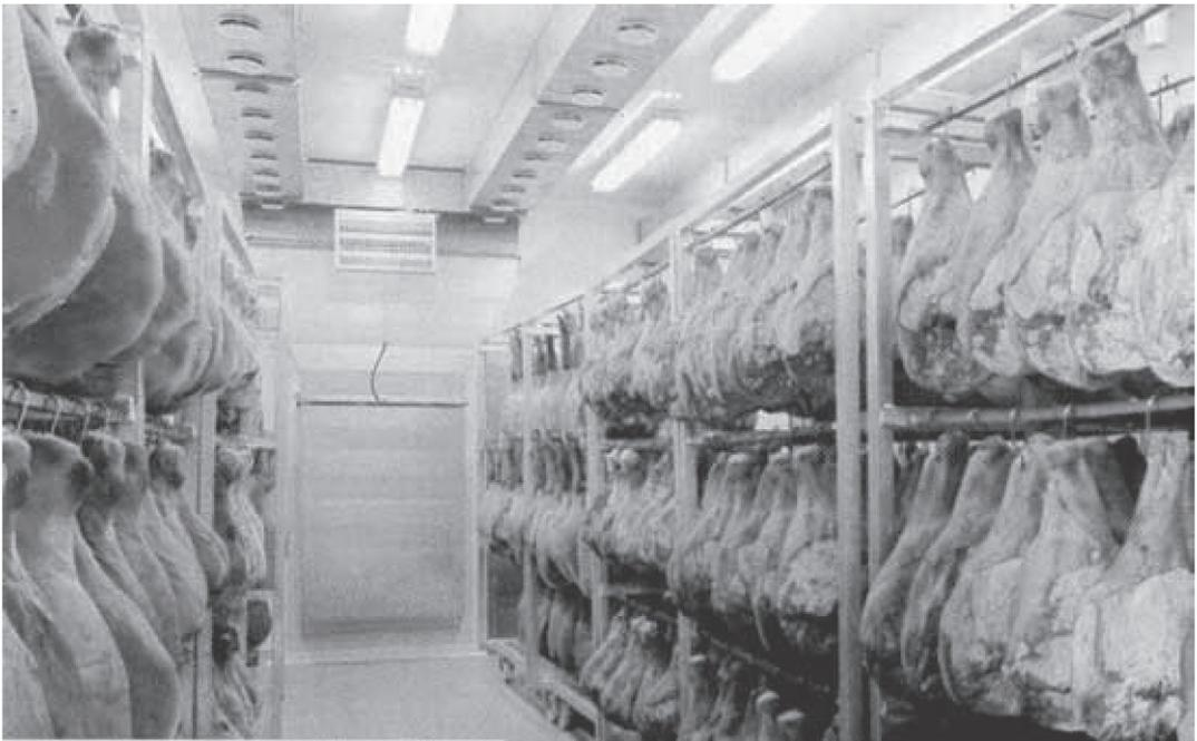
Figura 15. Disposición de Jamones en Cámara Industrial de Secado.
