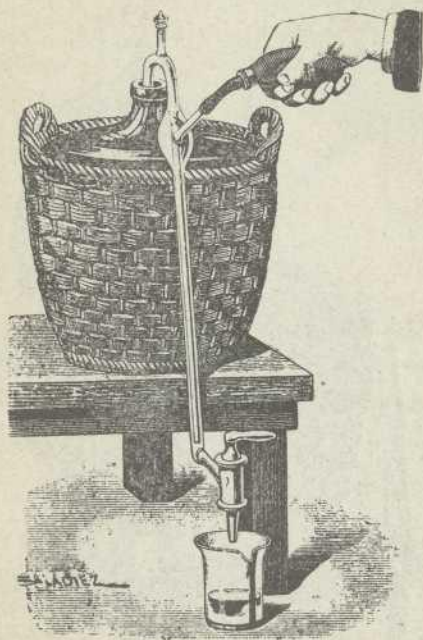
Sifón neumático del Sr. Leliebre para el trasvase de líquidos corrosivos (fig. 47)
