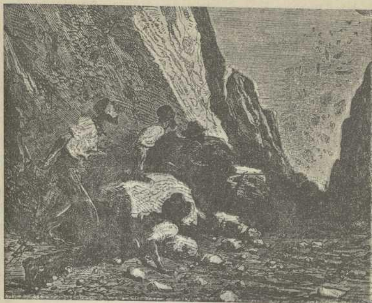
Explosión de dinamita para hacer volar una roca en una cantera (fig. 39)
