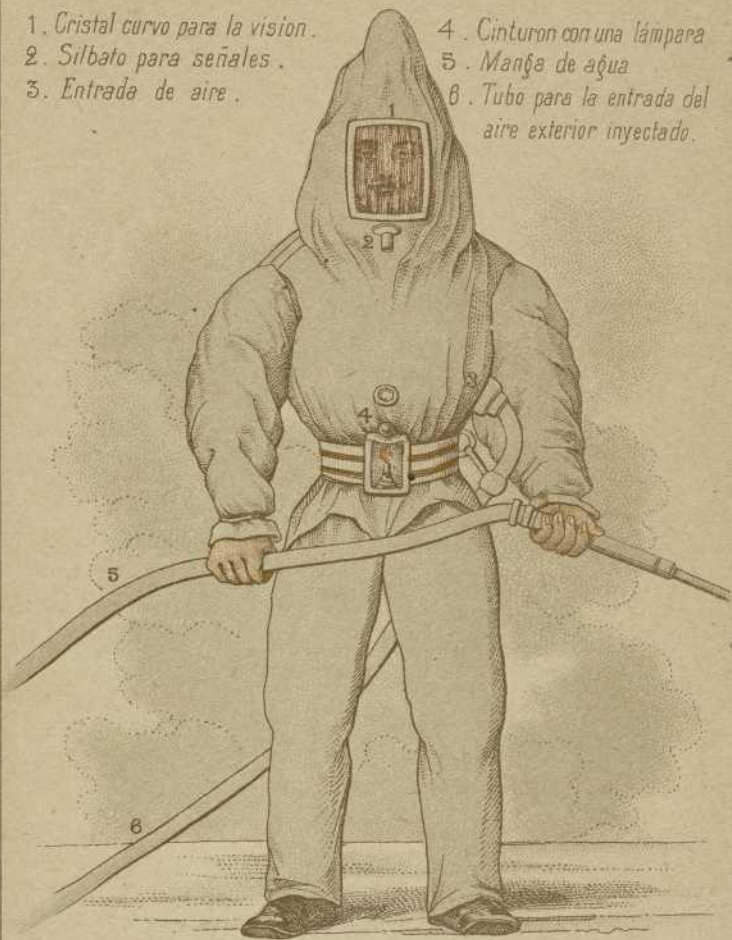
VESTIDO DE AMIANTO INCOMBUSTIBLE SISTEMA PAULIN PARA PENE- TRAR EN LAS PIEZAS INCENDIADAS
