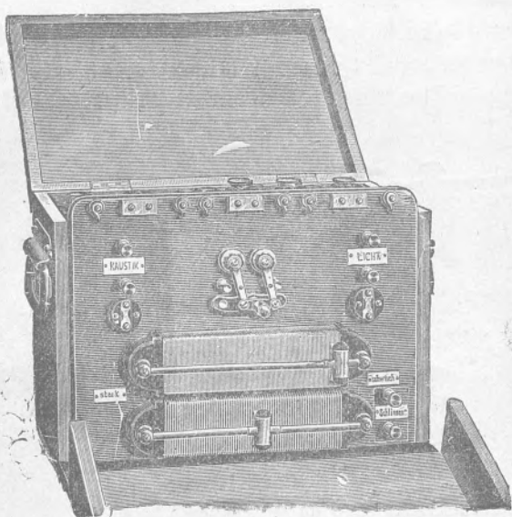
(Fig. 150.) Batería de acumuladores para galvanocauteria y eudoscopia
