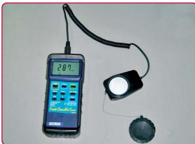
Para poder medir el nivel de luz de la estancia se utiliza el luxómetro.
