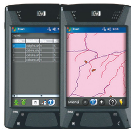
Imagen de dispositivos móviles con la MicodataPAD 2.0 de digitalización de muestreos micológicos en tiempo real
