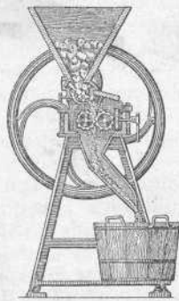
Máquina de prensar manzanas.
