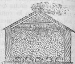
Corte de un horno de yeso.
