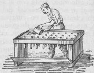
Fabricación de las velas de estearina y parafina.
