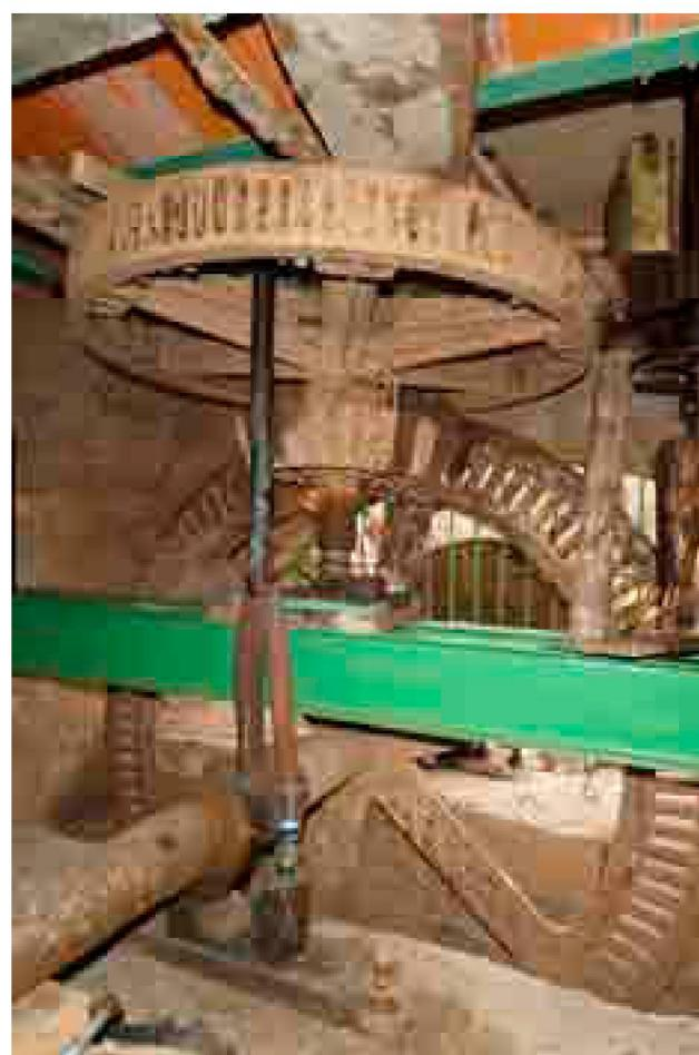
DETALLE ENGRANAJES DE LA PLANTA DEL CÁRCAVO.
