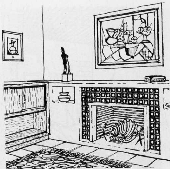
Fig. 25. — Chimenea chapada con azulejo.
