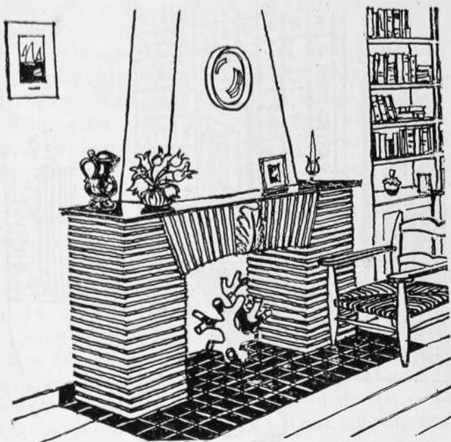
Fig. 24. — Chimenea revestida con ladrillo.
