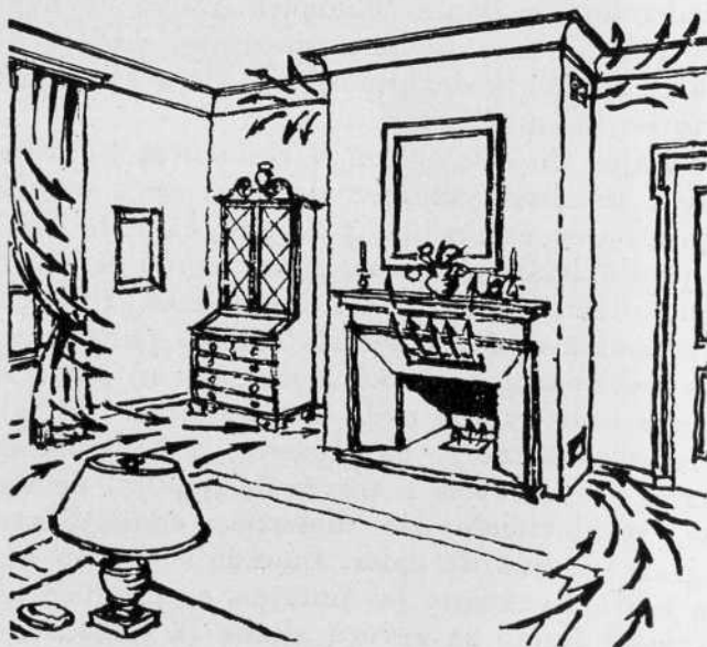
Fig. 2.--Esquema de circulación de aire en una chimenea moderna con producción de aire caliente.
