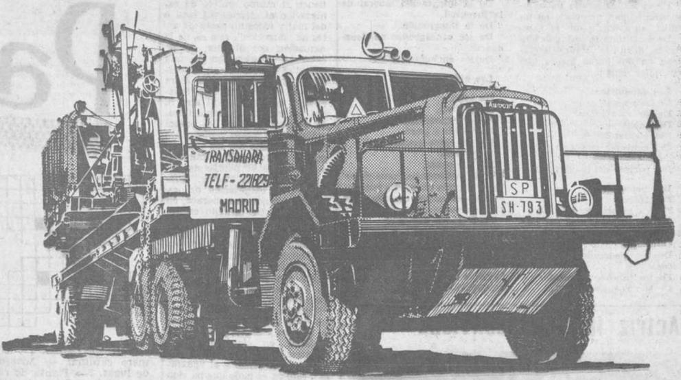
**TRACTO-CAMION AUTOCAR 220 H. P. Y SEMI-REMOLQUE PLATAFORMA DE 30 Tn. DE CAPACIDAD DE CARGA**
