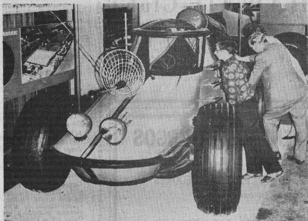
Una firma holandesa, la Vredestein, ha construido ya el coche que podrá utilizarse en la Luna. Es precisamente el que vemos en esta fotografía. Está especialmente diseñado para las características del terreno lunar, con ruedas neumáticas que impedirán enterrarse o patinar en la arena. La cabina va herméticamente cerrada y todas las piezas en general están recubiertas de una especie de membrana o capa contra los finos polvos cósmicos. Lleva también antenas exteriores y tanques de oxígeno, además de los correspondientes faros para su utilización en las zonas oscuras. A esto se le llama previsión del futuro. — (Foto FIEL)
