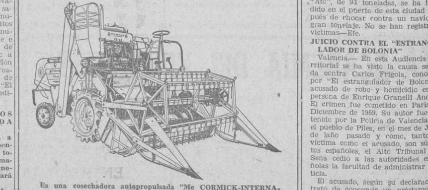
Es una cosechadora autopropulsada «McCORMICK-INTERNACIONAL». Con motor Diesel «INTERNATIONAL» de 35 H.P. y 4 cilindros verticales. Ancho de corte, 2'15 y 2'62 metros. Velocidad de propulsión variable. Control hidráulico de la plataforma de corte. Tres sacudidores de gran capacidad. Molinete articulado. Limpia final por selector de granos.
