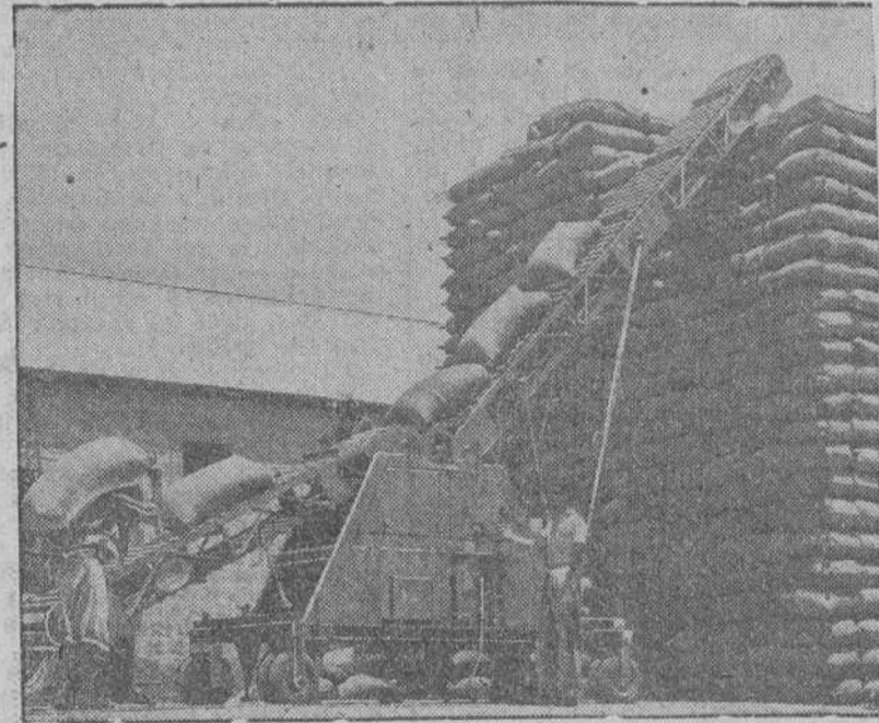
Esta moderna máquina elevadora de cereales, creación de la industria británica, aplica a más altura cada vez unos cinco mil sacos en una sola jornada de trabajo.—(Foto C.)
