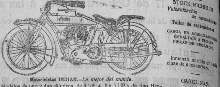
Motocicletas INDIAN.—La mejor del mundo. Modelos de uno y dos cilindros, de 3 1/2, 4, 5 y 7 HP y de tipo Hendes Special, con arranque, alumbrado y klaxon eléctrico, contador kilométrico é indicador de velocidad.
