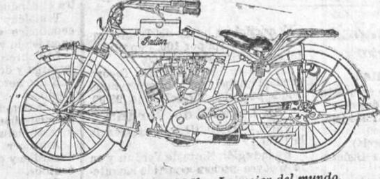
**Motocicletas INDIAN.** — La mejor del mundo. Modelos de uno y dos cilindros, de 3 1/2, 4, 5 y 7 H.P. y de tipo Handon Special, con arranque, alumbrado y klaxon eléctrico, contador kilométrico é indicador de velocidad.
