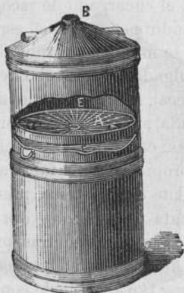
Fig. 126.—Vasija cilíndrica con flotador para trasportar la crema á la fábrica de mantera.
