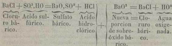
Para finalizar la operacion, se añade al liquido la cantidad estrictamente necesaria de sulfato argéntico, que pueda eliminar todo el ácido hidroclopórico bajo la forma de cloruro argéntico insoluble; por manera, que solo queda en definitiva una corta porcion de ácido sulfúrico, del sulfato argéntico empleado, v. gr.
