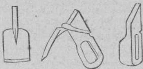
Esta pequeña herramienta, compuesta de una hoja acerada, y de un mango de madera dura al cual está aquella sujeta
