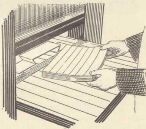
Fig. 278. Dispositivo para el corte de tiras estrechas.
