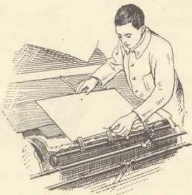
Fig. 281. Modo de colocar la puntura inferior.
