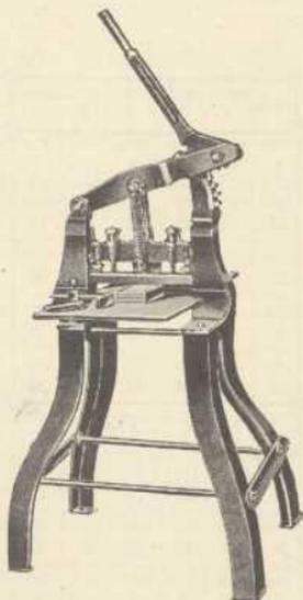
Fig. 360. Máquina modelo B E para el trepado de los blocks.
