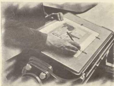
Fig. 210. Indicación de las guías en un pliego de prueba.
