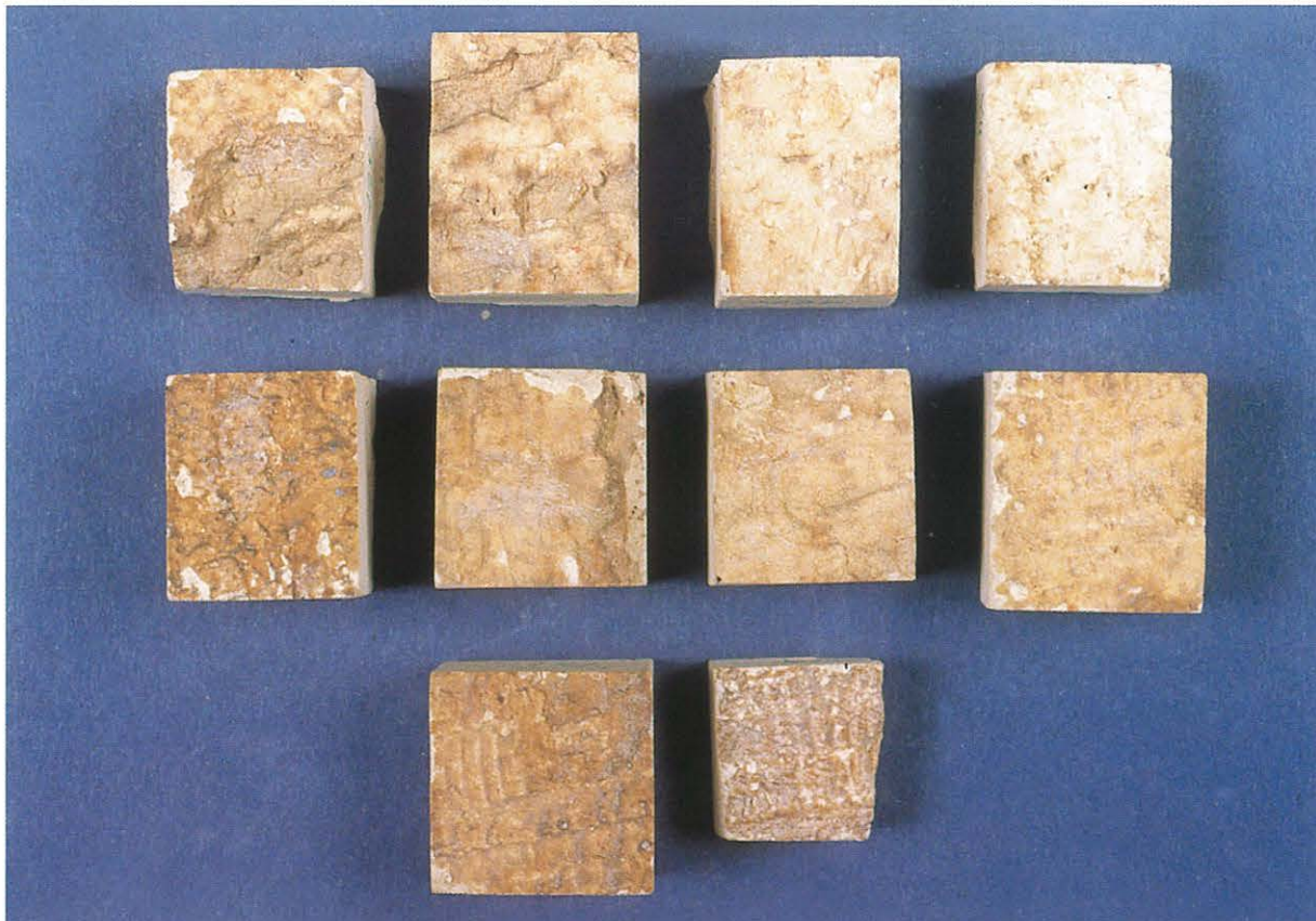
Probetas pátina cornisa Colegio Santa Cruz. Arriba derecha: pátina. Izquierda limpieza mecánica. Centro (dcha a izqda): 76, 155, 232, 308 mJ/cm 2 . Abajo (dcha a izqda) 123, 247, 371, 494 J/cm 2
