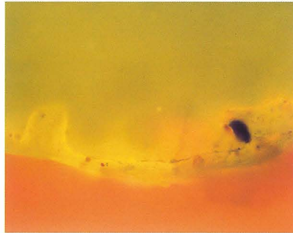
Estratigrafía de la pintura original de la fachada de la Iglesia de S. Pablo. Observación bajo fluorescencia
