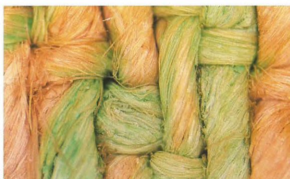
Ligamento sarga; fibras teñidas por resinato de cobre
