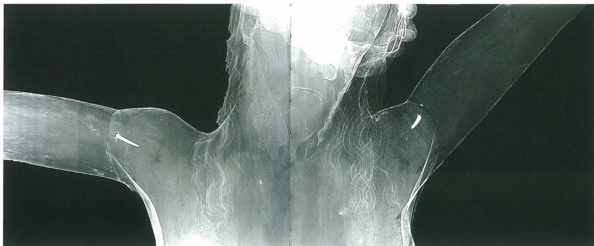
Estudio radiográfico de alteración de ensamblajes
