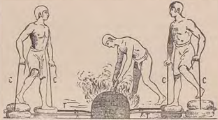
Fragua egipcia. Las letras C C indican las cuerdas con que se levantaban las tapas de los fuelles, y las T T los tubos que conducían á la fragua la corriente de aire producida por el peso del cuerpo del operador al gravitar sobre las tapas de los fuelles.
