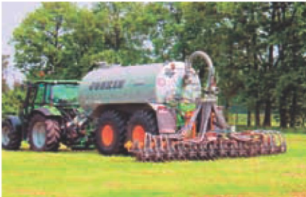
Sistema de inyección de estiércol.
