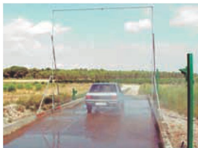
Desinfección externa de vehículo por aspersión.
