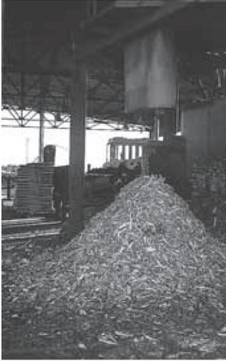
Figura 23: Residuo tratado apto para ser introducido en el horno.
