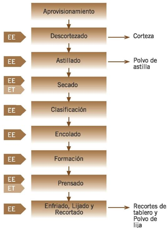
Figura 6. Proceso Productivo: Fabricación de Tableros de Partículas.
