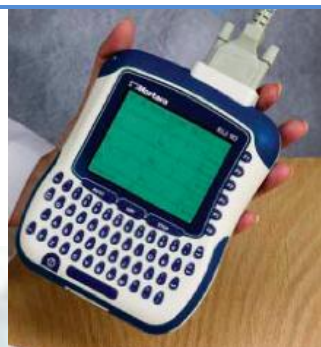
Telecardiógrafo. Realiza ECG y lo trasmite al Sº de Cardiología del Hospital de referencia
