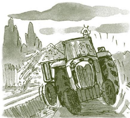
⊗ **Vuelco con aperos:** se produce por excesivo peso del apero, enganche excesivamente alto o laboreo muy profundo.
