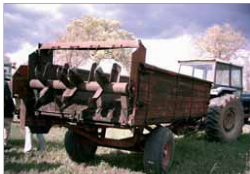
3.1: esparcimiento mecánico mediante un remolque esparcidor. Lo utilizaremos en grandes extensiones
