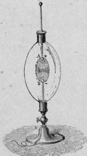
351. Globo eléctrico para la descarga en el vacío.
