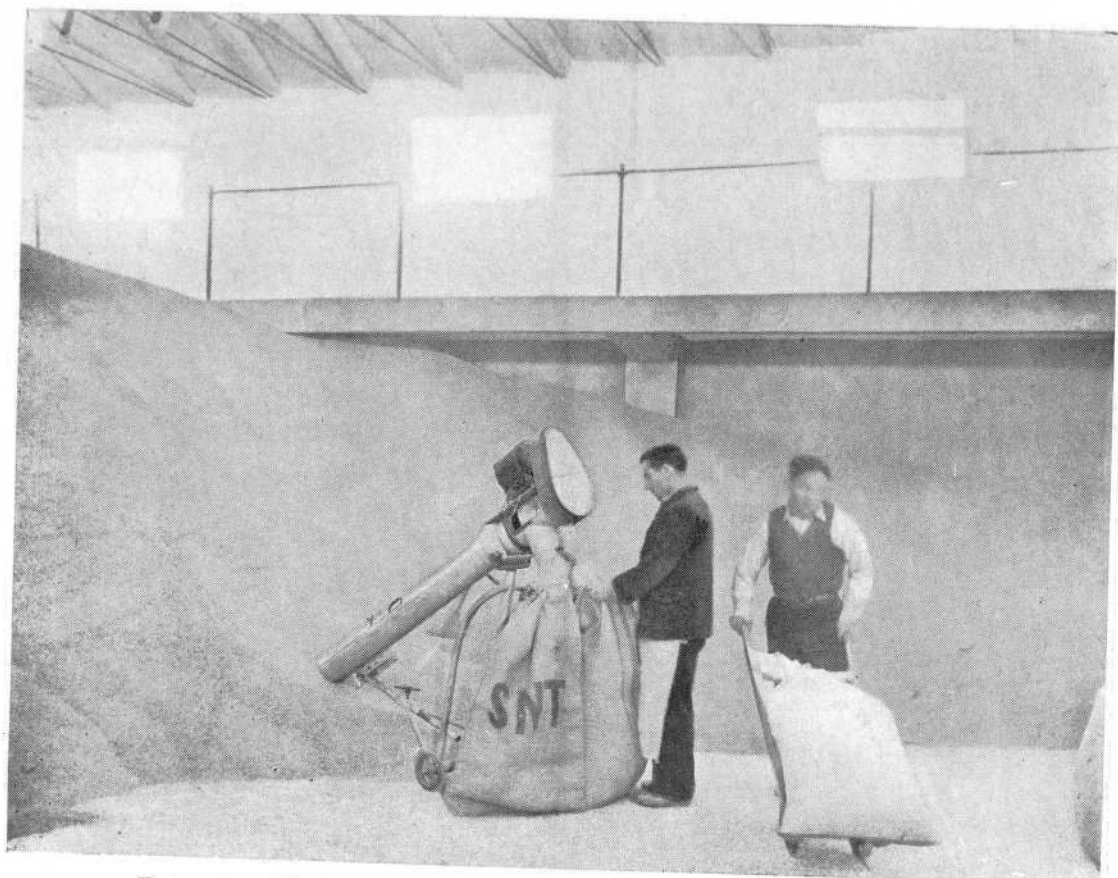
Foto núm. 12.—Almacén de Boceguillas. Ensacado mecánico del grano.
