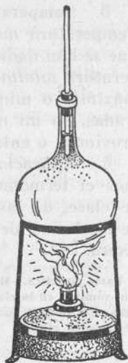
Al calentarse el agua del matraz, se dilata y sube por el tubo
