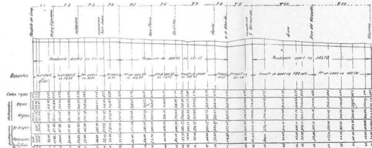
Tubería maestra. — Perfil longitudinal
