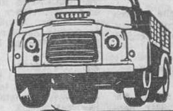
TIPOS FH-800 y FF-800 (SERVO DIRECCION) MOTOR BMC. 125 HP CAJA + CARGA 9.000 Kgs.
