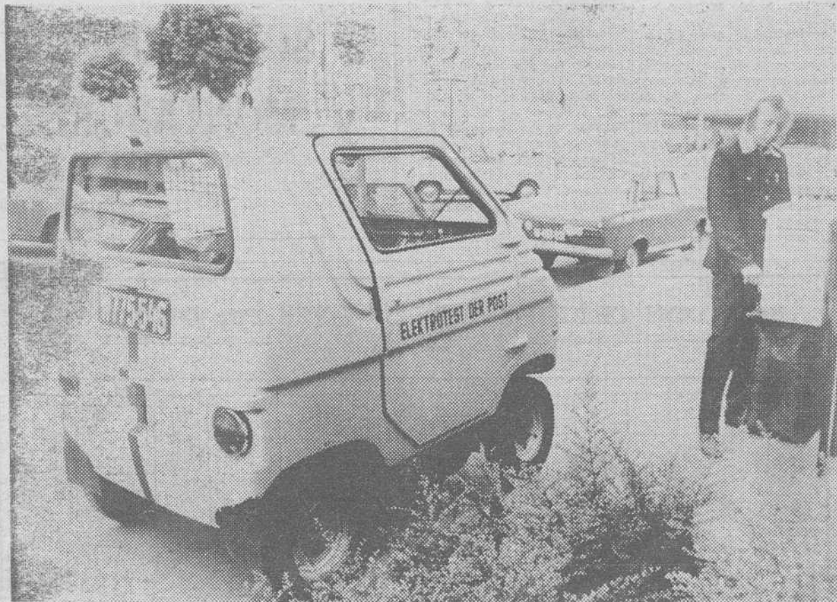
La Administración de Correos de Austria está probando actualmente un coche eléctrico para la recogida y distribución del correo en Viena. El vehículo, un «Zagato Zele 1.000», tiene 4,8 HP. y una velocidad máxima de 50 Kms. hora. — (Foto FIEL).
