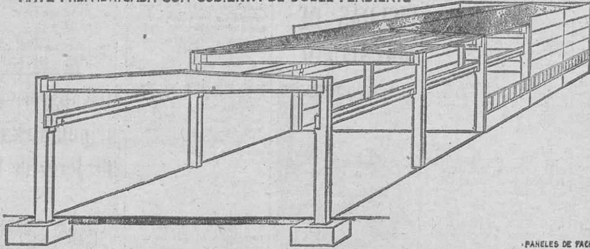
NAVE PREFABRICADA CON CUBIERTA PLANA
