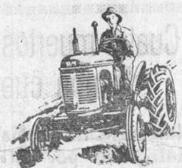
Puede arar con Brabant número 1, remolcar 2.500 kilos, segar con gavilladora o atadora, trillar con máquina pequeña o con tres trillos de disco o pedernal, etc.
