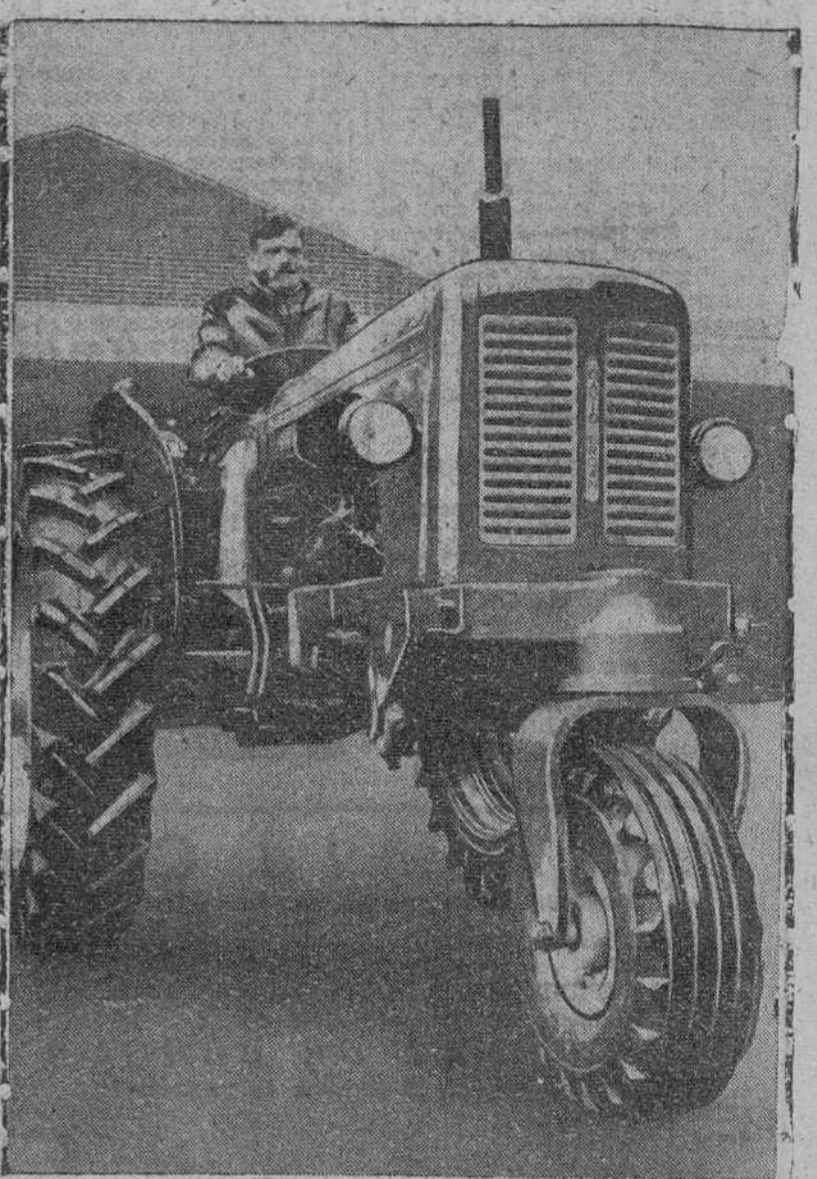
Después de realizar intensos trabajos de desarrollo y pruebas en el terreno, una firma de Yorkshire (Inglaterra), ha puesto a la venta un nuevo tractor de tres ruedas llamado "D. B. 903". Las nuevas máquinas, se utilizan para trabajos de cultivo en hileras de maíz, caña de azúcar y algodón. Con una separación del suelo de 73,6 cm., el tractor puede trabajar fácilmente sobre las plantas. Una de sus principales características es la excelente manobra, pues puede girar en un corto espacio y, con la ayuda de los frenos independientes de las ruedas, evoluciona en los lugares más estrechos. El "903" está impulsado por un motor Diesel de 40 caballos y cuatro cilindros, a posee seis velocidades adelante y dos atrás. Por esta razón, la máquina se puede emplear en la velocidad más eficiente, según las condiciones de cada trabajo.—(Foto C.)
