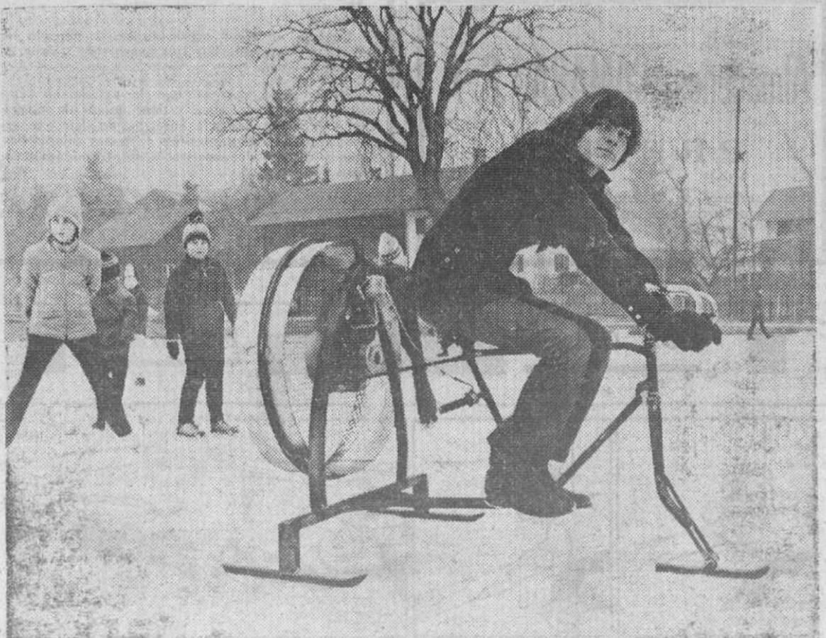
Irschenhausen (Baviera).— El poven Sebastián Heinsdorf ha construido ese trineo especial para deslizarse sobre las aguas heladas de los lagos de la región. Ha utilizado el cuadro de una bicicleta y la hélice de un camión, movida por el motor de una motocicleta. —(Foto CIFRA GRAFICA).
