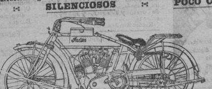
Motocloletas INDIAN. - La mejor del mundo. Modelos de uno y dos cilindros, de 3 12, 4, 5 y 7 H.P. y de tipo Hendes Special, con arranque, alumbrado y klaxon eléctrico, contador kilométrico é indicador de velocidad.
