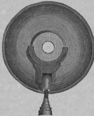
*Fig. 52.*—Vista posterior del espejo cóncavo con una montura destinada á recibir una lente de correccion ( $\frac{1}{2}$  de aumento).
