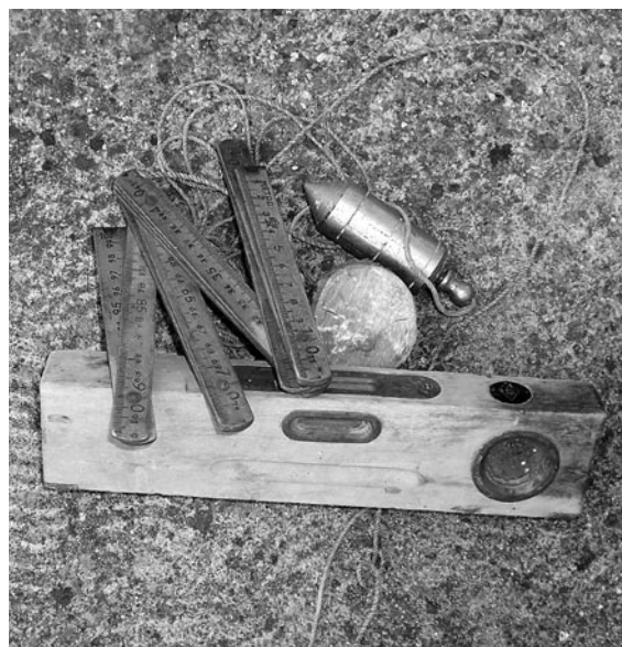
Metro, plomada y nivel, instrumental imprescindible para el maestro tapiador.
