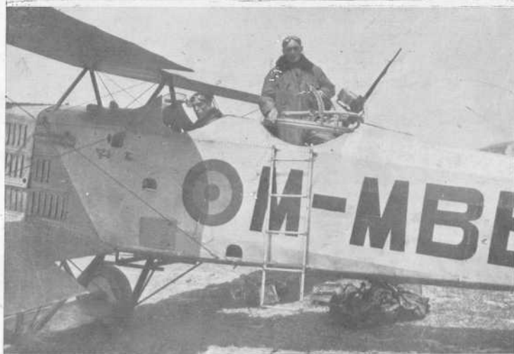
Arriba: Vista de Sevilla desde un aeroplano, a 800 m. de altura. Abajo: Aeroplano español (M) militar (M), tipo «Breguet» (B) de reconocimiento, con ametralladora. (Las restantes letras corresponden a la serie y al número del aparato.)
