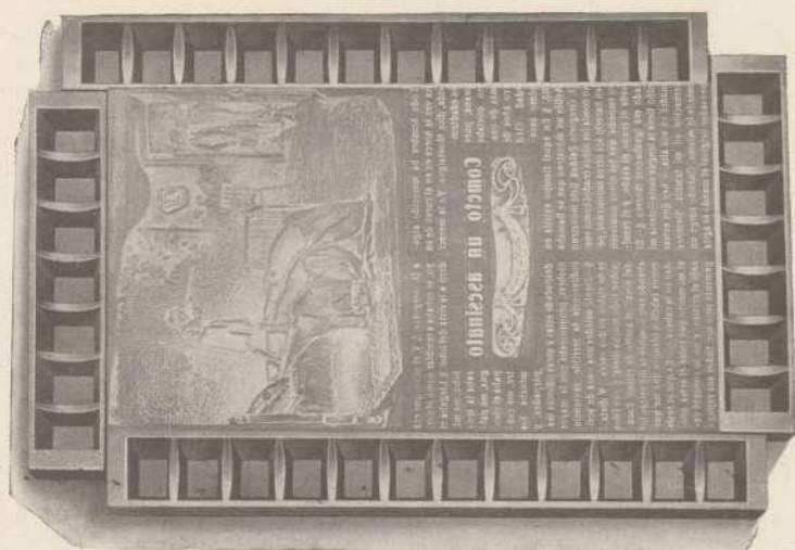
Fig. 122. —Manera de imponer un molde tamaño prolongado . Imposiciones contrapeadas .
