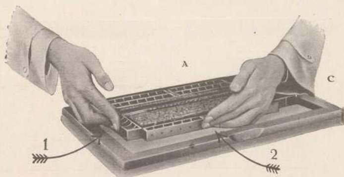
Fig. 129.—Manera de ajustar el molde a las imposiciones en los tamaños apaisados.
