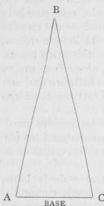
Fig. 127. — Medida de la distancia de un punto inaccesible.
