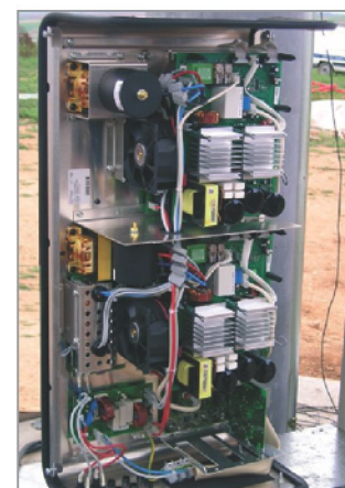
Interior de un Inversor para instalación fotovoltaica de conexión a Red
