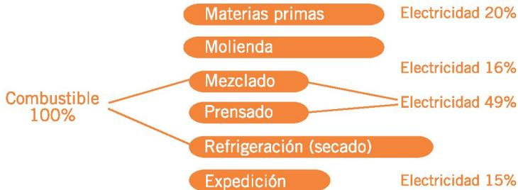
Figura 4: Esquema productivo de la fabricación de piensos.
