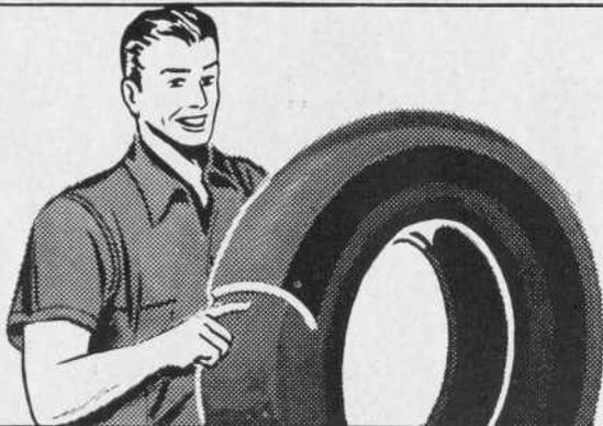
Reconstrucción es la reposición de la superficie de rodamiento y revestimiento de los costados. La reconstrucción se aplica en general a las gomas que tienen los hombros cuarteados o muestran señales de separación exterior.
