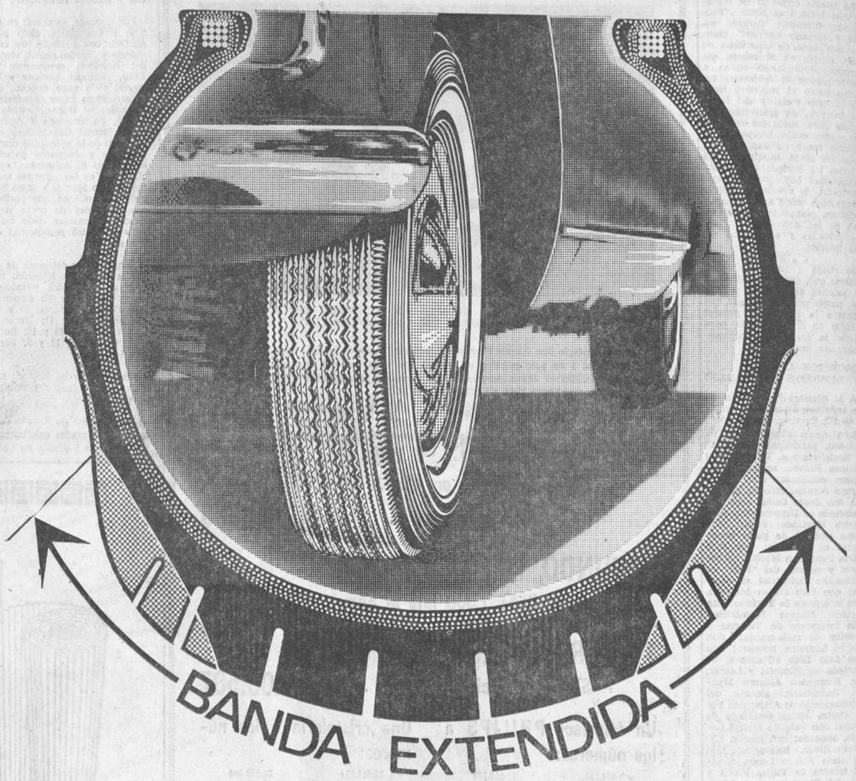
Fijese bien... El DURA-JET no es un neumático como los demás. En su Banda Extendida el dibujo en zig-zag se prolonga sobre los hombros. Esto le asegura el control de su coche y tracción positiva, aún en las más duras condiciones.
